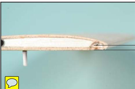
● Reporter la cote comprise entre l'intrados de l'aile et le centre du trou de la commande dans l'aile..
