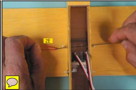
● Réaliser un crochet en CAP 1mm (non fourni) pour pouvoir passer et tendre l'élastique 2E qui maintient les ailes plaquées contre le fuselage
