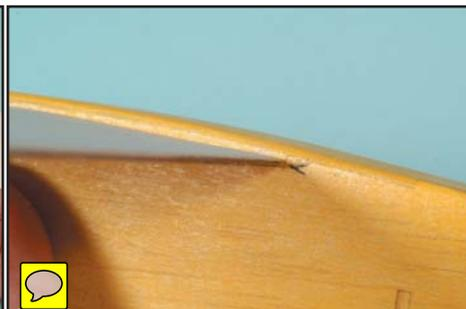
● Amener les bords de fuite des ailes en face des repères gravés sur les flancs du fuselage. Immobiliser les ailes dans cette position (au neutre).
