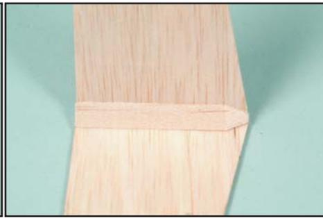
● La présenter sur l'empennage, ajuster si nécessaire.
