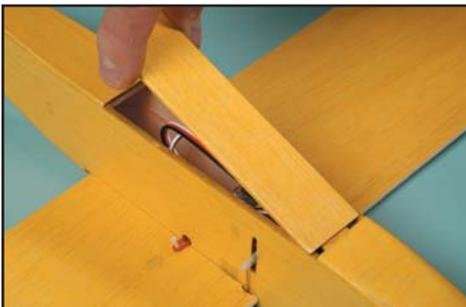
● Passer la languette de la trappe sous le coffrage à l'avant.
