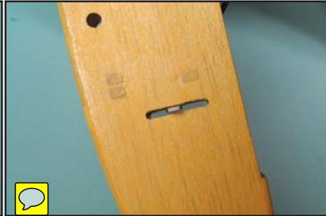
● Le palonnier doit être centré longitudinalement et latéralement dans la fente.
