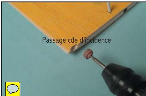
● Au niveau de la gaine posée dans l'aile à la construction pour les commandes d'incidence intégrale, fraiser l'emplanture comme sur la photo.
