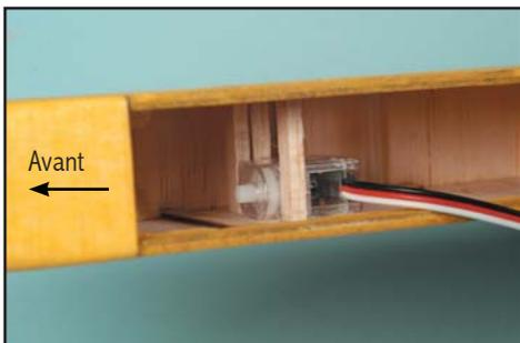
● Monter le premier servo comme sur la photo. La patte du servo vient s'insérer entre les 2 baguettes.
